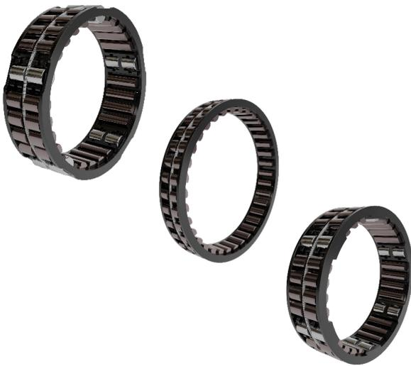
Käfigfreiläufe sind Klemmstück-Freiläufe ohne eigene Lagerung und werden vorzugsweise zwischen kundenseitigen Innen- und Außenringen eingebaut. Sie sind als Rücklaufsperre, Überholkupplung oder Vorschubfreilauf einsetzbar.
