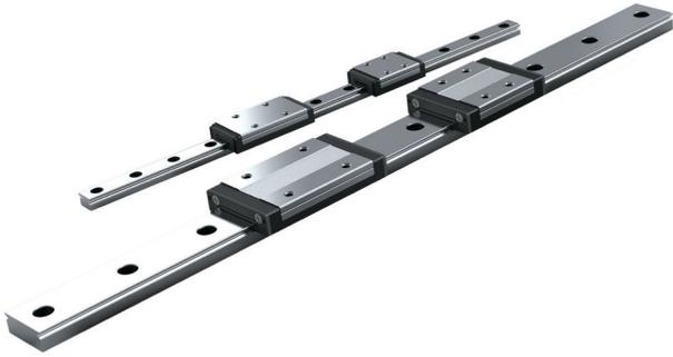
Die MSC/MSD-Edelstahl-Serie ist eine 2-reihige Linearführung mit 4-Punkt Vorspannung und gotischem Laufbahnprofil
