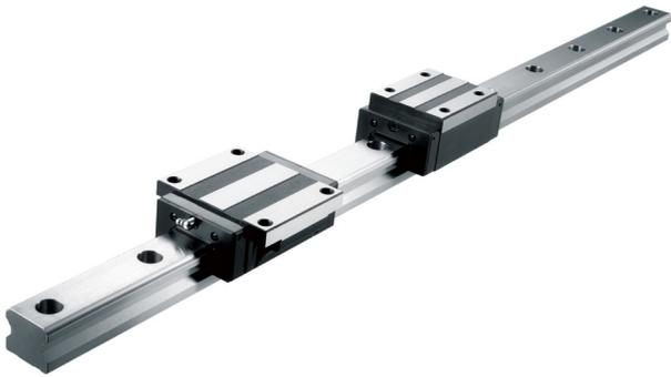
Die MSA- und MSB-Serie Linearführungen sind mit vier separaten Kugelumläufen und einem 45°-Druckwinkel entwickelt, was die gleiche Tragfähigkeit aus allen Lastrichtungen gewährleistet. Sie eignen sich für verschiedene Installationsmethoden an den X-, Y- und Z-Achsen und können gleichmäßig vorgespannt werden.
