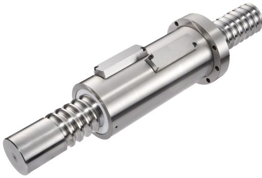
Es wurden Optimierungen am Typ FSVH/FSDH vorgenommen (größerer Kontaktwinkel, Kugeldurchmesser, Kugelrückführung), um die dynamische Tragfähigkeit im Vergleich zum Vorgängertyp (FSVC) mehr als zu verdoppeln.
