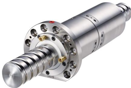
Durch mehrere umlaufende Kühlkanäle in der Mutter fließt Kühlflüssigkeit, die den Wärmeeintrag durch den Kugelgewindetrieb ins System auf ein Minimum reduziert. Wärmeenergie wird durch die Mutterkühlung absorbiert, wodurch der Wärmeeintrag in Umbauteile effektiv vermieden wird.
