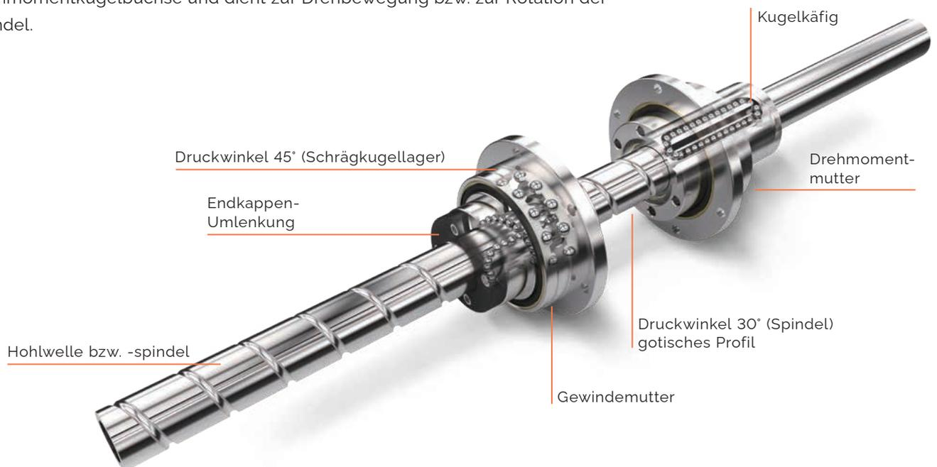
Das Hub-Dreh-Modul verfügt damit über drei Bewegungsmodi (rotierend, linear und spiralförmig) mit einer einzigen Welle durch Drehen oder Stoppen der jeweiligen Mutter.
